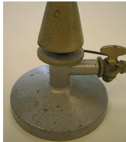
④ Obere Schraube etwas aufdrehen, Gasbrenner mit blauer Flamme.
