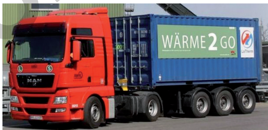
Aufgabe 5: Mobiler Wärmespeicher
