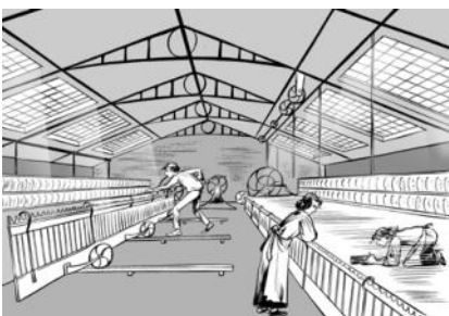
Fabriksaal mit Wagen-Spinnmaschinen (England um 1835)
