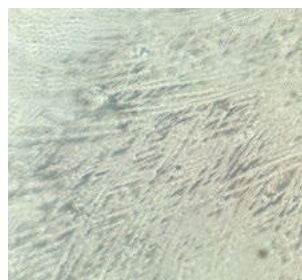
Acetylsalicylsäure kristallisiert aus einer warmen gesättigten Wasser-Ethanol-Lösung
