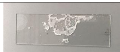
Am Ende des Experiments sieht man auf dem Deckträger eine Schicht Salz.
