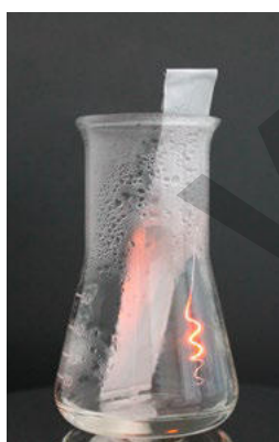
1 | Glühender Platindraht beim Erhitzen des Propylenglycols
