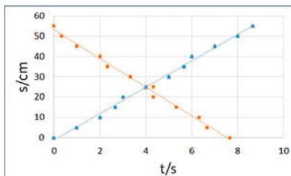
Abb. 2: Weg-Zeit-Diagramm der gleichförmigen Bewegung der Lokomotive, Rückwärtsfahrt (orange) und Vorwärtsfahrt (blau)
