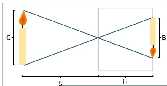
**Abb. 2:** Skizze zur Funktionsweise einer Lochkamera
