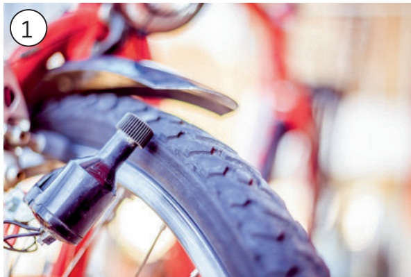
Abb. 1: Wie viel Energie liefert wohl ein Dynamo am Fahrrad? © Patrick Daxenbichler/iStock/Getty Images Plus; Abb. 2: Prinzipieller Aufbau; Abb. 3: Alternativer Aufbau mit Eisenkern; Grafiken: Dr. W. Zettlmeier
