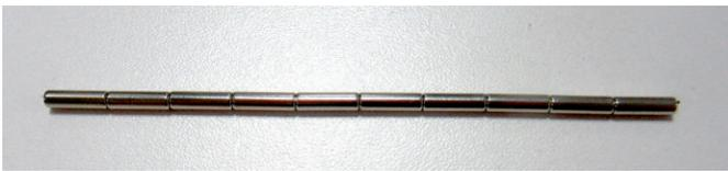
2. Untersuche, an welchen Stellen dieser lange Stabmagnet seine Pole hat. Prüfe dazu, an welchen Stellen du die Magnetkette mit dem Rand eines Centstücks anheben kannst. Notiere deine Beobachtungen.
