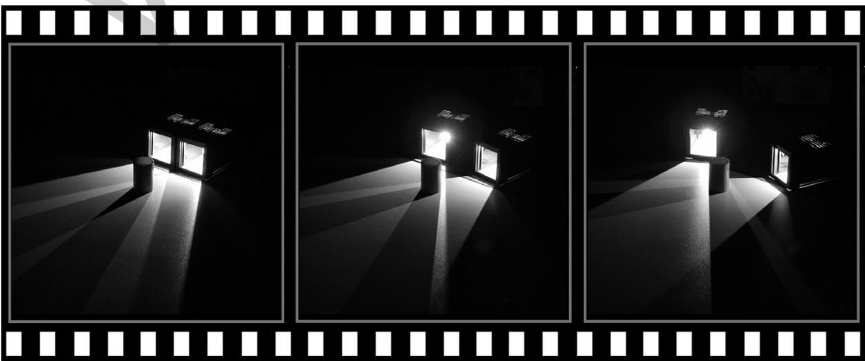
Abb. 7.6.4: Experimentierverlauf bei Variation des Abstandes der Leuchtkästen bei konstanter Entfernung zum Schattengeber. Beobachtung der Veränderung von Kern- und Halbschatten
