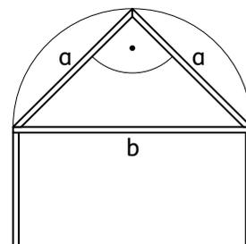
3. Tobias bereitet sich auf die nächste Sitzung vor: Durch die Stützbalkenkonstruktion in Aufgabe 2 entsteht ein rechtwinkliges Dreieck. Die gleichlangen Stützbalken haben die Länge  $a$ . Die Breite des Daches wird mit  $b$  bezeichnet. Aufgrund des rechten Winkels gilt die Formel  $2a^2 = b^2$ . (Die Formel gilt nach dem Satz des Pythagoras.)
