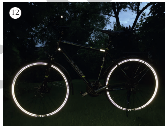
Abb. 12: Seitliche Blitzaufnahme eines Fahrrades, dessen Felgen mit Retro-Reflektorfolien beklebt sind.
