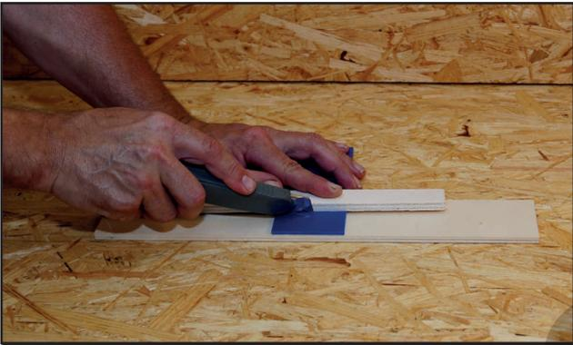
Zum Schneiden ein Stück Restholz unterlegen, damit der Tisch nicht beschädigt wird. Dann eine Leiste oder ein Stück Restholz mit gerader Kante anlegen (ein Metalllineal o.ä. macht die Klinge stumpf) und mehrfach die Linie nachziehen.
