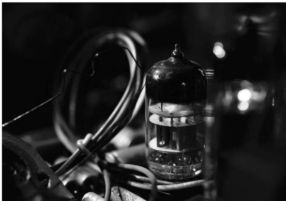
Abb. 3: Elektronenröhre in einem alten Röhrenradio
