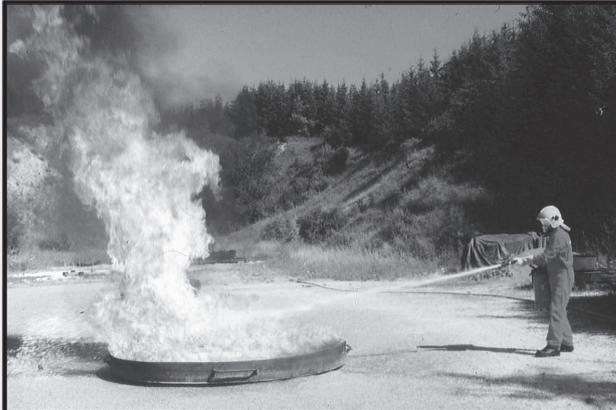
Die Löschwirkung eines Schaumlöschers wird vorgeführt.
