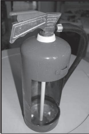
*Wasserlöscher der ständig unter Druck steht (Dauerdrucklöscher). Im Innern ist das Steigrohr zu sehen. Das Treibgas befindet sich über dem Löschmittel. Beim Öffnen des Löschers wird das Löschmittel durch das Treibmittel ins Rohr und ins Freie gedrückt.*
