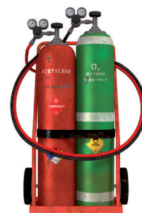
Acetylen und Sauerstoff in Stahlflaschen zum autogenen Schweißen
